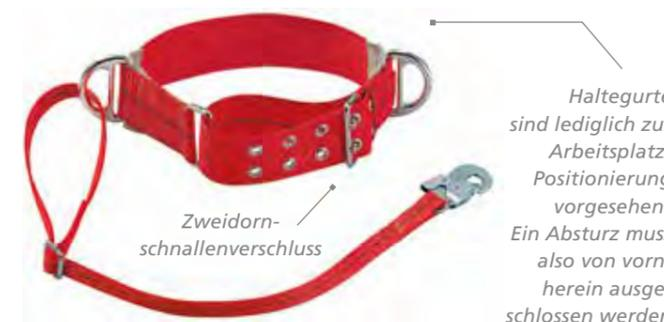
**MAS Haltegurt BmZ »B3R«** Haltegurt zur Arbeitsplatz-Positionierung mit 27 mm Gurtband, verstellbar mittels Reibschnalle, Zweidornsnallenverschluss, zwei seitliche Halteösen, Gurtlänge: 1,5 m, Bauchumfang: 100 – 110 cm, mit Karabinerhaken »MAS 51«, geprüft nach EN 358, Verstellbereich 10 cm, **Festigkeit:** Gurtband > 22 kN, im System > 15 kN.
