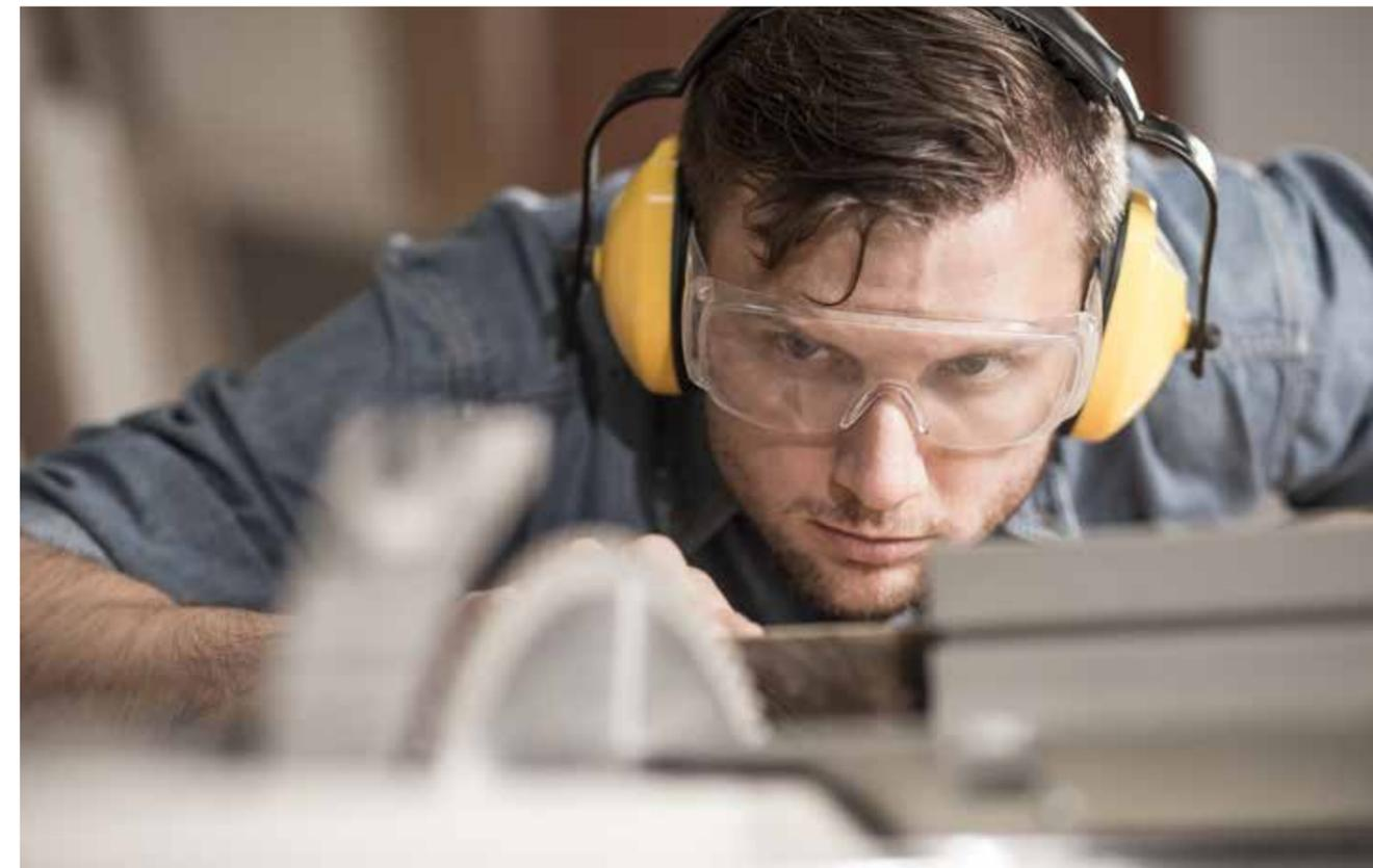
Der SNR-Wert (Single Number Rating) gibt Auskunft über die Schutzwirkung von Gehörschützern. Ein Produkt mit einem SNR-Wert von 35 dB dämmt z. B. eine Lärmbelastung von 100 dB auf 65 dB herunter.
