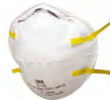
**FFP 1 3M™ Atemschutzmaske »8710E«** NR D, ohne Ausatemventil, vorgeformter Maskenkörper, flexible Nasenbügel, schützt bis zum 4-fachen des Grenzwertes, innovatives Filtermedium für sicheren Schutz und geringe Atemwiderstände, EN 149:2001 + A1:2009.
