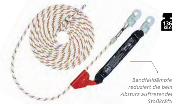
**MAS Auffanggerät »MAS SK12«** frei mitlaufendes Auffanggerät mit angenähertem Bandfalldämpfer, Länge: 15 m, 12 mm Polyester-Kernmantelseil und Nähte aus hochstrapazierfähigem Polyestergergarn, mit beidseitigen Stahl-Karabinerhaken »MAS 51«, Norm: EN 353-2, zul. Höchstgewicht: 136 kg.
