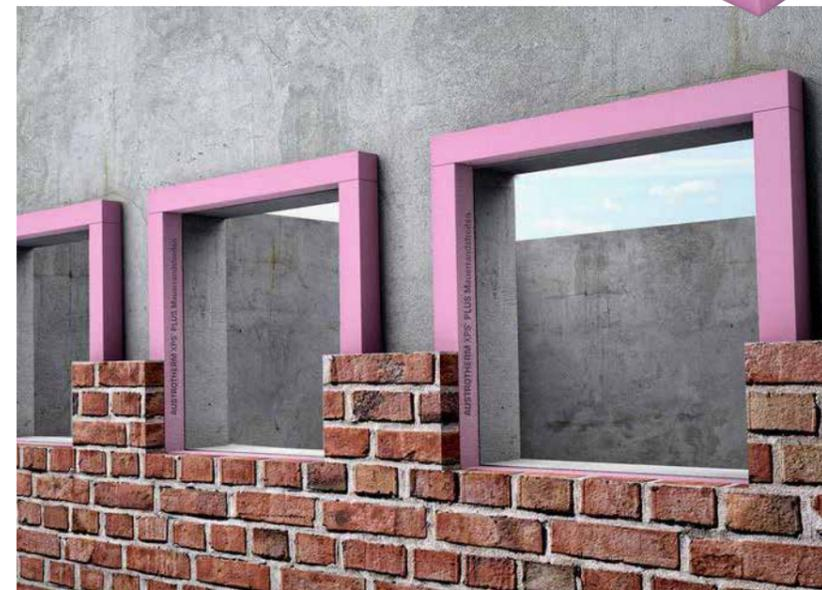
**238 Austrotherm XPS® PLUS Mauerrandstreifen:** Randabschluss für Tür- u. Fensteröffnungen im zweischaligen Mauerwerk/ Giebelbereich, Produkttyp: Nach EN 13164: XPS® (geprägte Oberfläche), Hergestellt aus Austrotherm XPS PLUS, extrudierter Polystyrol Hartschaum, rosa, Druckfestigkeit: Bei 10% Stauchung, 300 kPa (30 t/m<sup>2</sup>)  $\geq 300 \text{ kPa}$ , Wärmeleitfähigkeit: 80 mm:  $\lambda_D = 0,032 \text{ W/(mK)}$ .
