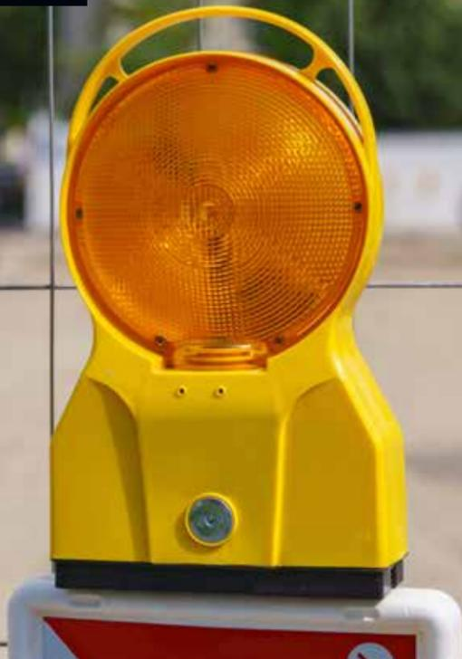
**179 WEMAS TL-Warn- und Bakenleuchte Typ »Future«:** BASt-geprüft, HDPE, mit Tragegriff, Dämmerungsautomatik und LED-Funktionskontrollanzeige, Blink-/Dauerlicht, entspricht EN 12352 - L6.
