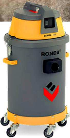
**213 Ronda Industriesauger »300 - NT«:** Zum Nass- und Trockensaugen ohne Filterwechsel, synthetischer Auffangbeutel, Sortierung von Partikeln/Flüssigkeit, große Filterfläche, robustes Design. 106250
