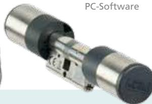
**258** ABUS Profilzylinder »C73 N vs«: Beidseitig schließbar, 5-Stift-Zylinder mit parazentrischem Schlüsselprofi, verschleißarme Werkstoffe, Messing matt vernickelt, inklusive 3 Schlüsseln. Verschiedene Längen bis 50/60 mm erhältlich. 110542
