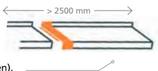
**195 Eckverbinder:** Einfache Verbindung von Fensterbänken, die über eine Ecke gehen.
