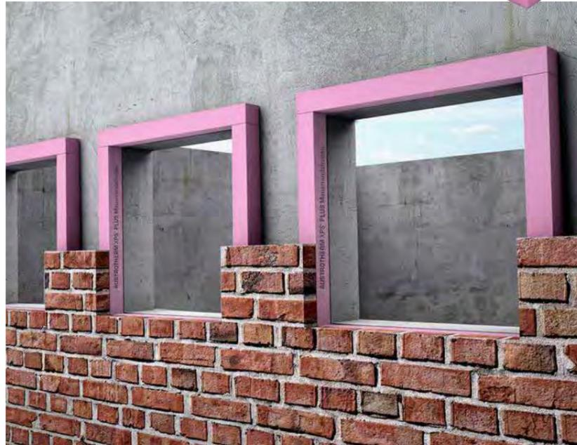
**178 Austrotherm XPS® PLUS Mauerrandstreifen:** Randabschluss für Tür- u. Fensteröffnungen im zweischaligen Mauerwerk/ Giebelbereich, Produkttyp: Nach EN 13164: XPS® (geprägte Oberfläche), Hergestellt aus Austrotherm XPS PLUS, extrudierter Polystyrol Hartschaum, rosa, Druckfestigkeit: Bei 10% Stauchung, 300 kPa (30 t/m<sup>2</sup>)  $\geq 300 \text{ kPa}$ , Wärmeleitfähigkeit: 80 mm:  $\lambda_D = 0,032 \text{ W/(mK)}$ .
